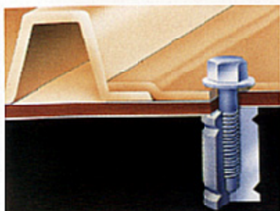
Fixation du lest avec insert en acier.
